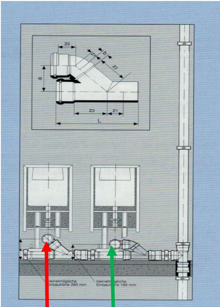
Einbauhöhe 45° Abzweiger mit Bogen 260 mm
