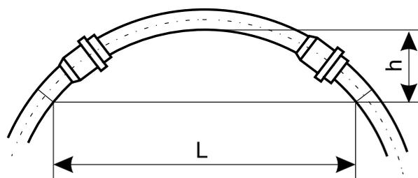
(Трубы диаметром > DN 200 могут только немного изгибаться из-за высокой собственной жесткости)
